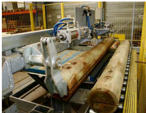
PREMONTAGGIO DEI CORRENTI ORIZZONTALI
