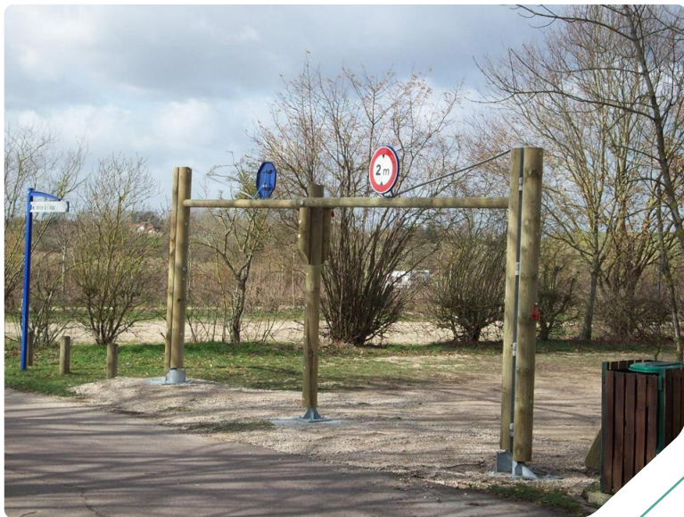
Portique de gabarit à verrouillage central pour – Syndicat du Lac de Der (51)
