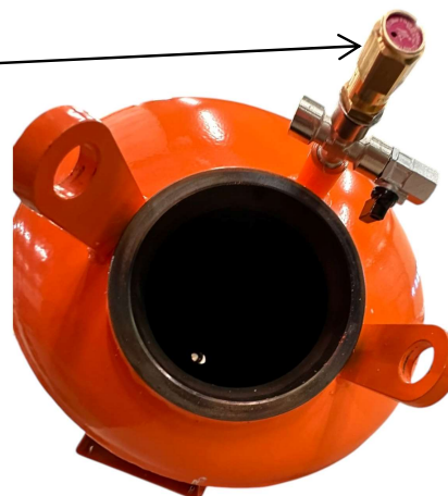
Vue de dessus – réservoir billeur sans couvercle et soupape de sécurité
