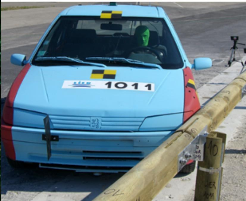
Les essais de chocs ont démontré que la robustesse et la capacité de déformation des glissières mixtes SOLOWOOD® sont équivalentes à celles observées sur les glissières de sécurité en acier.
