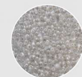
Revêtement rétro réfléchissant à microbilles de verre
