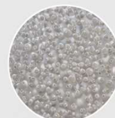
Revêtement rétro réfléchissant à microbilles de verre
