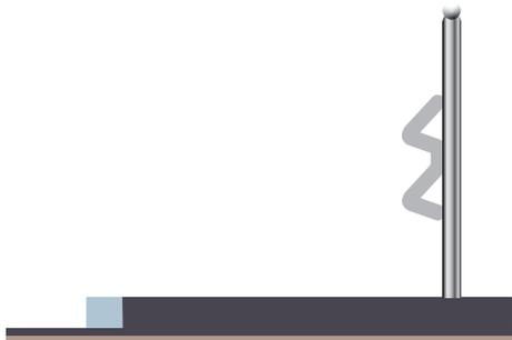
Barrière de niveau N ou H1 avec fonction garde-corps intégrée
