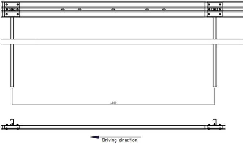
Le dispositif de retenue **simple file à battre dans le sol UNISAFE EASY 4.0** est composé d'éléments protégés contre la corrosion conformément à la norme EN 1461. La longueur des lisses horizontales et des supports détermine le format d'un élément. Le dispositif se caractérise par un **entraxe de supports de 4,00 m** et par des **lisses de 4 m** fixées aux **supports (longueur 1,60 m)**. Les lisses de glissière se chevauchent et sont fixées par plusieurs assemblages vissés.
