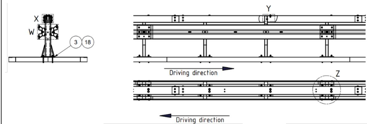
Le dispositif de retenue **double file sur platine UNISAFE DOUBLE 1.33 BW** est composé d'éléments protégés contre la corrosion conformément à la norme EN 1461. La longueur des lisses horizontales et des supports détermine le format d'un élément. Le dispositif se caractérise par un **entraxe de supports de 1,33 m** et par des **lisses de 4 m** fixées aux **supports (hauteur 875 mm)**. Les lisses de glissière se chevauchent et sont fixées par plusieurs assemblages vissés.
