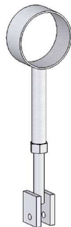
Détail de la suspente
