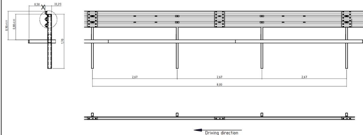
Le dispositif de retenue **simple file à battre dans le sol UNISAFE 3W 2.66** est composé d'éléments protégés contre la corrosion conformément à la norme EN 1461. La longueur des lisses horizontales et des supports détermine le format d'un élément. Le dispositif se caractérise par un **entraxe de supports de 2,66 m** et par des **lisses de 4 m** fixées aux **supports (longueur 1,70 m)**. Les lisses de glissière se chevauchent et sont fixées par plusieurs assemblages vissés.
