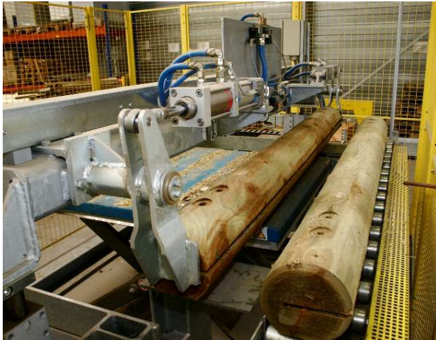
PREMONTAGE DES LISSES HORIZONTALES
