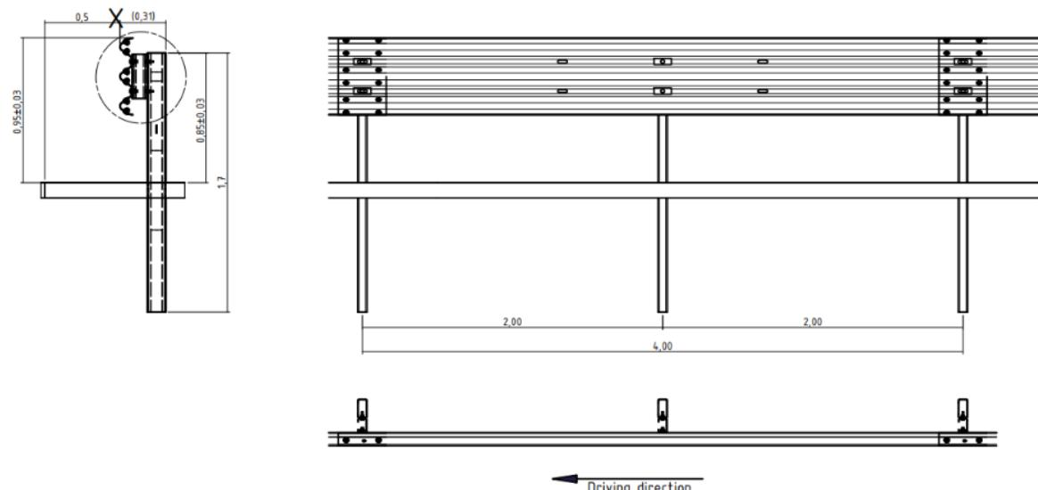
Le dispositif de retenue **simple file à battre dans le sol UNISAFE SM 3W 2.00** est composé d'éléments protégés contre la corrosion conformément à la norme EN 1461. La longueur des lisses horizontales et des supports détermine le format d'un élément. Le dispositif se caractérise par un **entraxe de supports de 2,00 m** et par des **lisses de 4 m** fixées aux **supports (longueur 1,70 m)**. Les lisses de glissière se chevauchent et sont fixées par plusieurs assemblages vissés.
