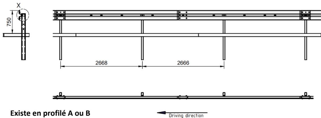
Le dispositif de retenue **simple file à battre dans le sol UNISAFE 2.66** est composé d'éléments protégés contre la corrosion conformément à la norme EN 1461. La longueur des lisses horizontales et des supports détermine le format d'un élément. Le dispositif se caractérise par un **entraxe de supports de 2,66 m** et par des **lisses de 4 m** fixées aux **supports (longueur 1,50 m)**. Les lisses de glissière se chevauchent et sont fixées par plusieurs assemblages vissés.
